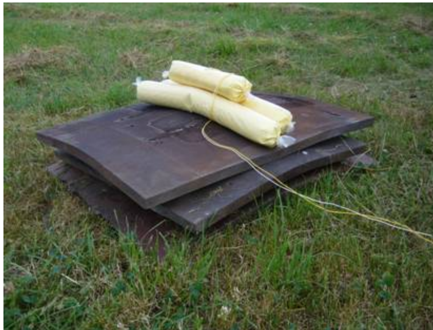
Obrázek 9: Výbušný systém před umístěním křemenného písku; Autor: Michaela Havlová.
