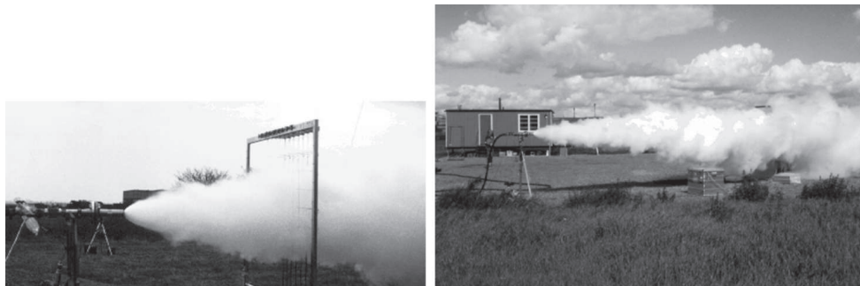
Obrázek 34: Dvoufázový únik zkapalněného amoniaku simulující únik ze železniční cisterny (armaturou pro stáčení) (Kiša a kol., 2007). (Foto: Risø National Laboratory).
