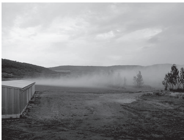
Obrázek 33: Vzhled oblaku aerosolu rozptylujícího se jako těžký plyn (snímek pořízený při terénních testech projektu SPREAD zachycuje tvar oblaku 120 sekund po úniku ze zdroje); (foto: Petr Skřehot).
