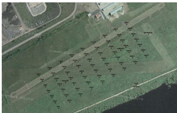
Obrázek P2-12: Vizualizace tvaru detekční sítě a rozmístění jednotlivých terčů, meteorologických stanic a epicentra výbuchu; Autor: Slavoj Zemánek.
