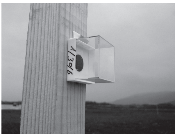
Obrázek P2-11: Pohled na pasivní detektor (detektor je po sejmutí plastového víčka připraven k expozici); Autor: Tomáš Vítek.
