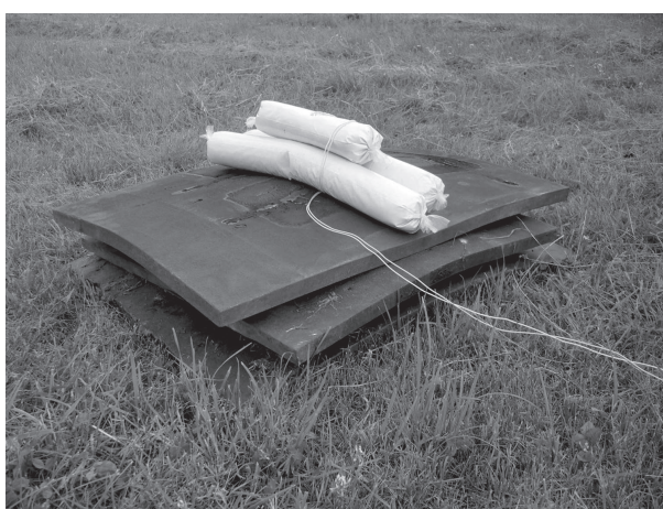
Obrázek P2-9: Výbušný systém před umístěním křemenného písku; Autor: Michaela Havlová.
