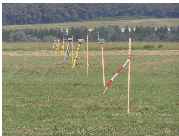
Obrázek P2-13: Rozmístění aktivních detektorů DustTrak; Autor: Petr Skřehot.
