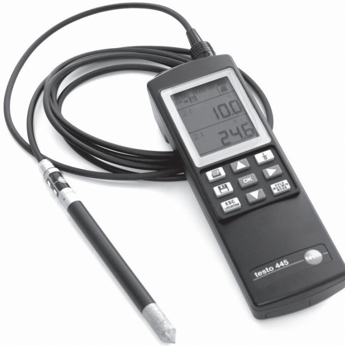
Obrázek 43: Měřící systém Testo 445 pro měření teploty vzduchu, relativní vlhkosti vzduchu a rychlosti proudění (zdroj: internet).
