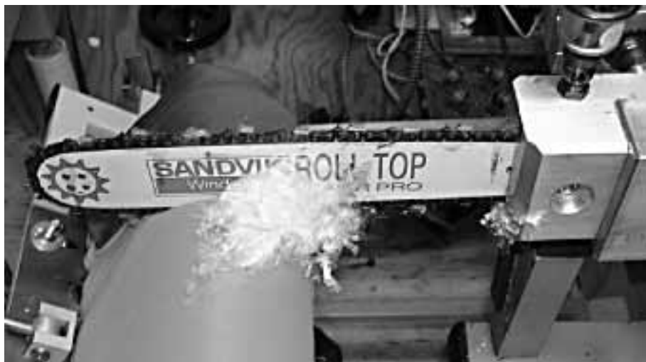
Obrázek 6: Ochrana na principu zbrzdění řetězu (autor Karel Škréta).
