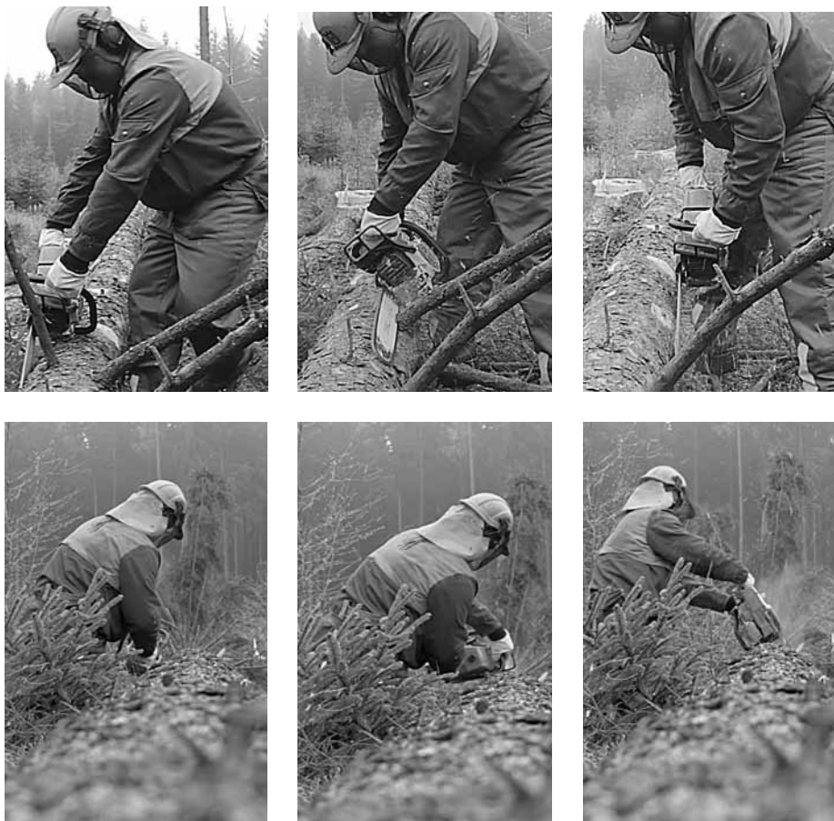
Obrázek 50: Odvětvování pomocí severské metody (foto autor).
