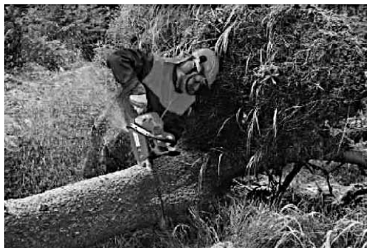
Obrázek 86: Při odřezávání kořenového koláče hrozí jeho zvrácení a zavalení dřevorubce [ČESKÁ LESNICKÁ AKADEMIE TRUTNOV, 2003].
