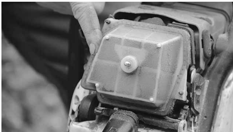
Obrázek 38: Kontrola prachového filtru (foto autor).
