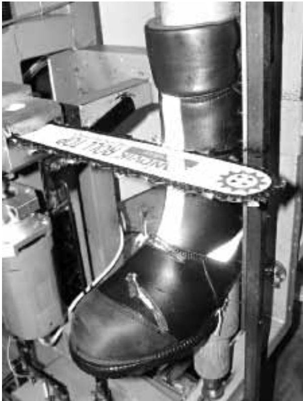
Obrázek 4: Ochrana na principu odolného materiálu (autor Karel Škréta).
