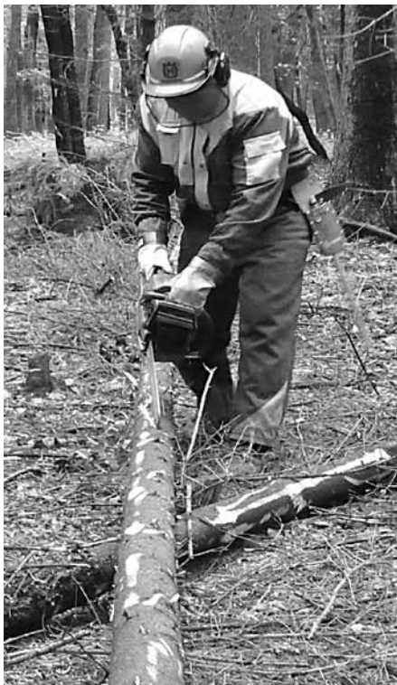
Obrázek 51: „Zvednutí“ odvětvaného kmene nad terén u švihové metody (foto autor).
