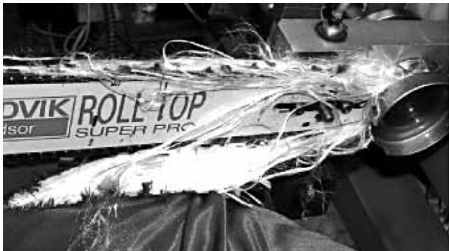
Obrázek 5: Ochrana na principu zanesení řezného ústrojí (autor Karel Škréta).
