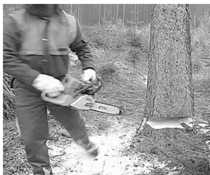
Obrázek 61: Zahájení ústupu dřevorubce směrem vzad od padajícího kmene [foto autora; VERLAG DASHÖFER, 2011].
