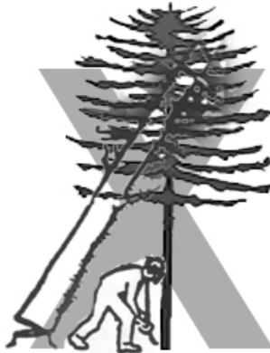
Obrázek 102: Zakázané práce - podřezávání stromu, o nějž je opřený zavěšený strom dle [VERLAG DASHÖFER, 2011].
