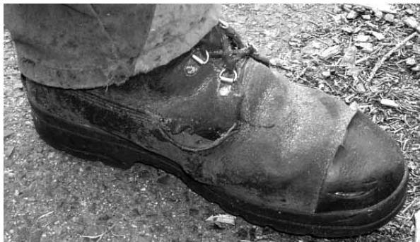
Obrázek 23: Pracovní bota poškozená příliš dlouhou dobou užívání (foto autor).
