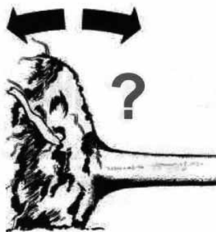
Obrázek 86: Při odřezávání kořenového koláče hrozí jeho zvrácení a zavalení dřevorubce [ČESKÁ LESNICKÁ AKADEMIE TRUTNOV, 2003].
