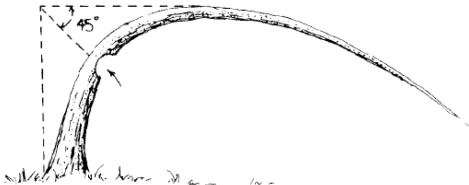
Obrázek 98: Provedení zářezu na straně tlaku při kácení ohnutého stromu [UNIVERSITY OF NEW HAMPSHIRE, 2001].
