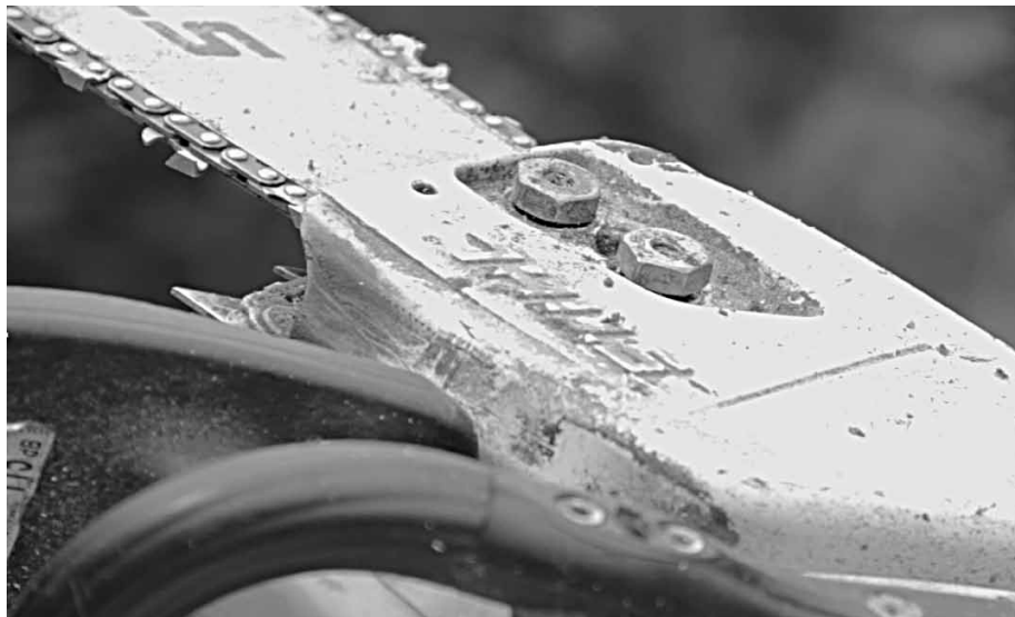
Obrázek 45: Kontrola dotažení šroubů a matic (foto autor).
