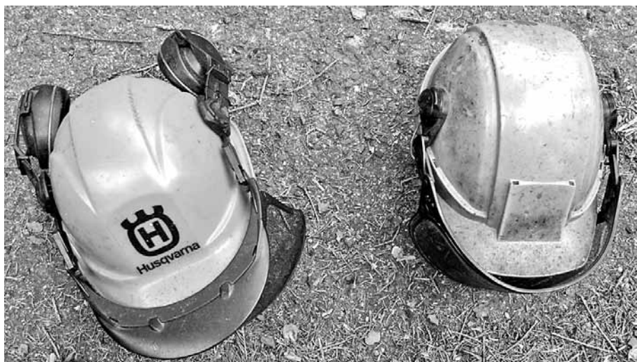
Obrázek 13: Zakrytí mezery mezi přilbou a štítem (foto autor).
