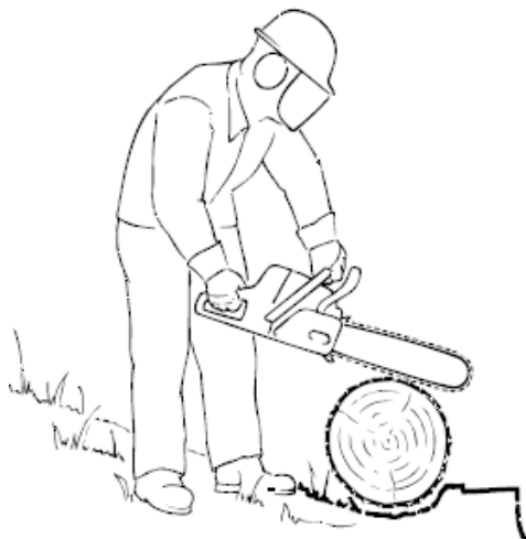
Obrázek 79: Pracovní pozice dřevorubce při práci ve svahu [CACH, 2010].
