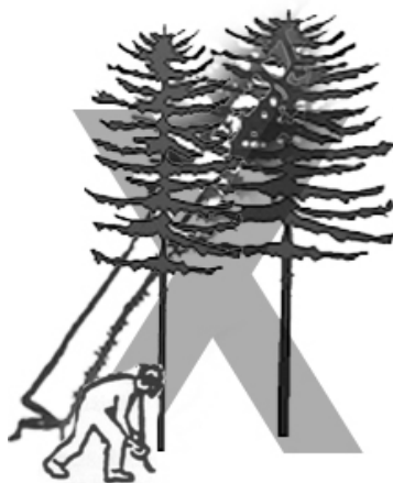
Obrázek 104: Zakázané práce – kácení stromu přes strom zavěšený dle [VERLAG DASHÖFER, 2011].
