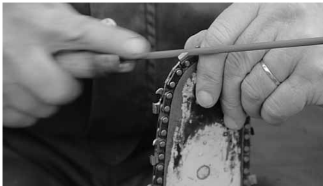
Obrázek 44: Kontrola a broušení řetězu (foto autor).
