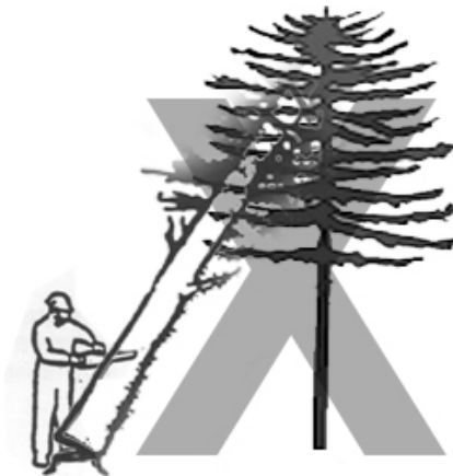
Obrázek 103: Zakázané práce – odřezávání zavěšeného stromu po špalcích dle [VERLAG DASHÖFER, 2011].
