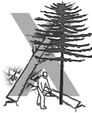
Obrázek 106: Zakázané práce – práce v blízkosti (nebezpečném prostoru) zavěšeného stromu dle [VERLAG DASHÖFER, 2011].
