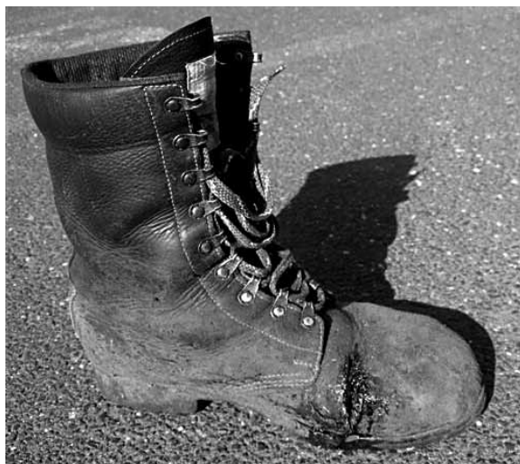
Obrázek 24: Pracovní bota poškozená pořezem pilou (autor Václav Brož).
