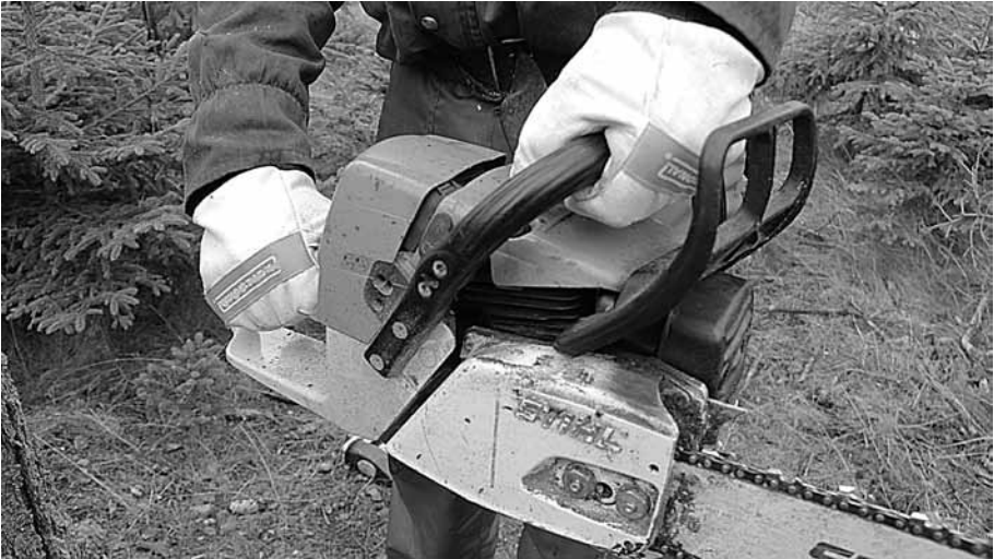
Obrázek 33: Správné držení pily při práci (foto autor).
