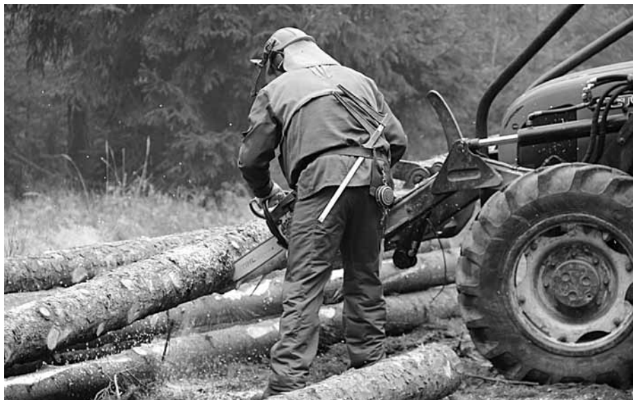
Obrázek 52: Zakázaný způsob sortimetnace (krácení „ve vzduchu“) (foto autor).
