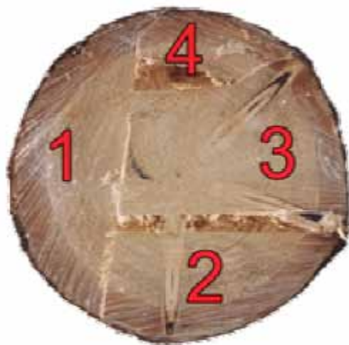
Obrázek 94: Pracovní postup při kácení silně napruženého kmene pomocí čtyř řezů [ČESKÁ LESNICKÁ AKADEMIE TRUTNOV, 2003].
