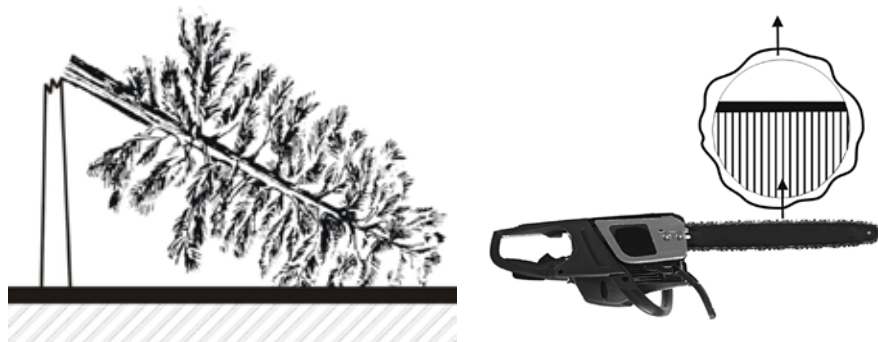
Obrázek 99: Provádění jednotlivých řezů při kácení zlomeného stromu do 1/3 své výšky s korunou opřenu zcela o zem dle [CACH, 2010].
