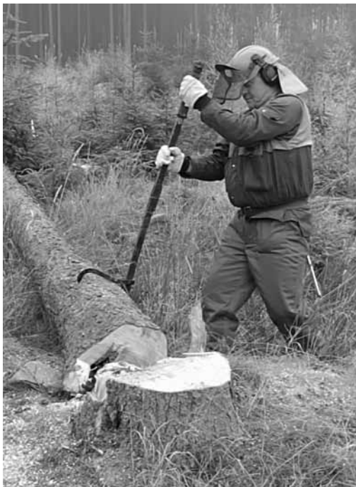
Obrázek 31: a) přetlačná lopatka s obracákem [HUSQVARNA, 2011]; b) manipulace s obracákem (foto autor).
