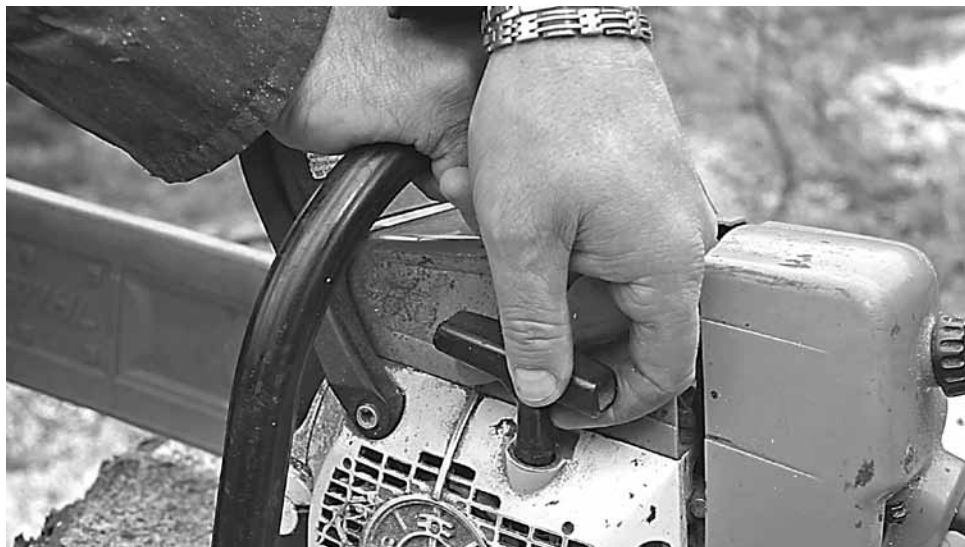
Obrázek 43: Kontrola stavu startovací šňůry (foto autor).
