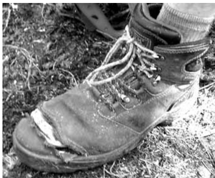
Obrázek 22: Pracovní bota po zásahu dobíhající řetězem pily (foto autor).
