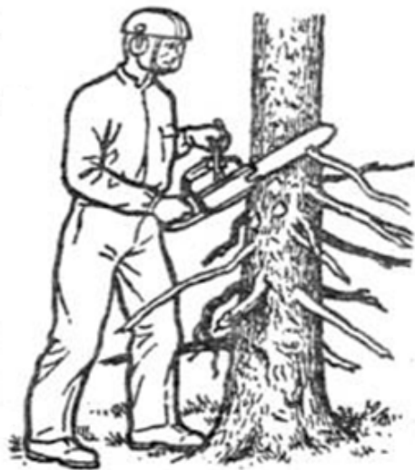
Obrázek 48: Správný postoj při odvětvování [VERLAG DASHÖFER, 2011].
