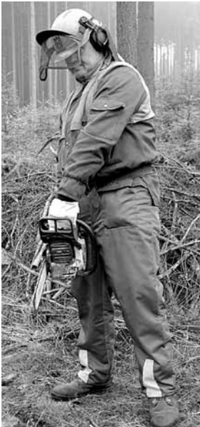
Obrázek 36: a) Správný postoj při práci s pilou (dřevorubec stojí mimo osu řezání); b) nesprávná práce s pilou (práce proti tělu) (foto autor).
