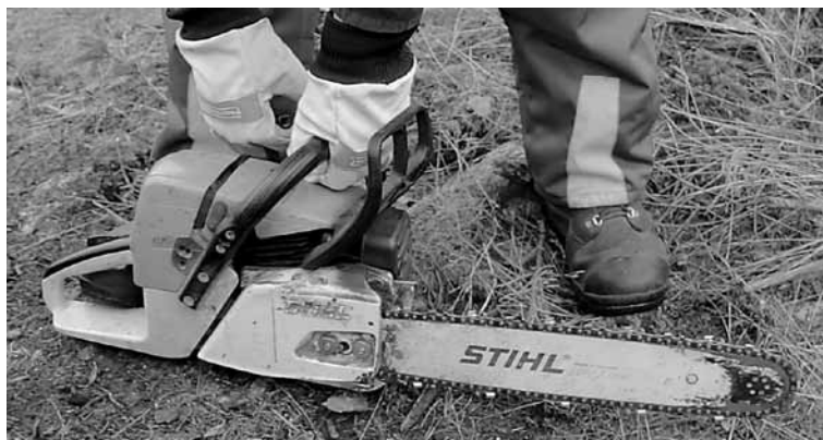
Obrázek 28: Správný způsob startování pily (foto autor).
