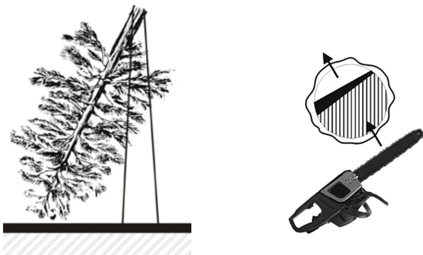
Obrázek 100: Provádění jednotlivých řezů při kácení zlomeného stromu do poloviny své výšky s korunou neopřenu zcela o zem [CACH, 2010].
