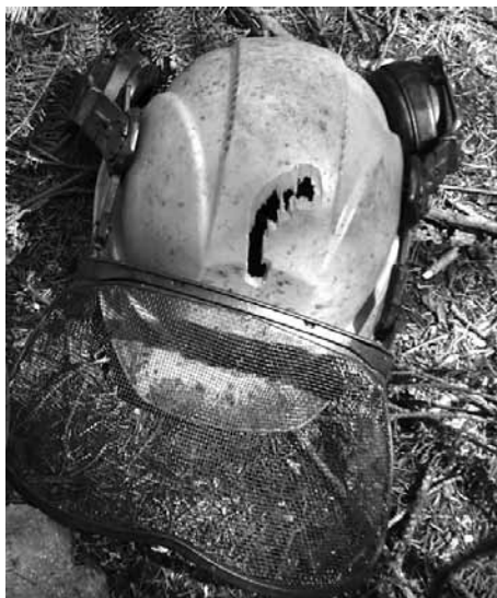
Obrázek 11: Ochranná přilba po zásahu řetězem motorové pily (foto autor).
