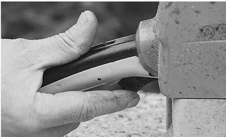
Obrázek 42: Kontrola plynové páčky a pojistky plynu (foto autor).
