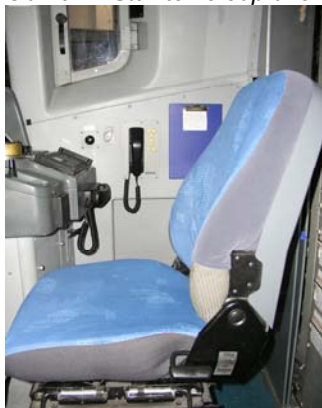
Obr. č. 4 Stavitelné odpružené sedadlo u Pendolina, ale bez opěry hlavy a rukou
