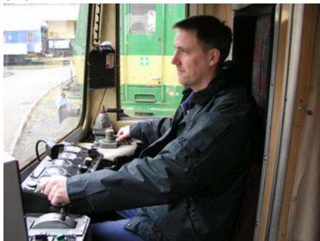
Obr. č. 1 Nedostatečný pracovní prostor strojvedoucího v hnacím motorovém vozidle řady 810
