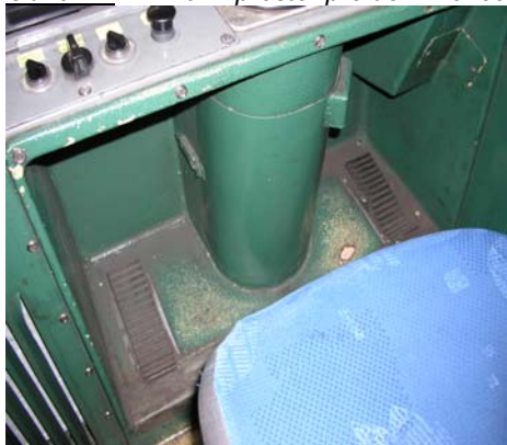
Obr.č. 2 Minimální prostor pro dolní končetiny při sezení u řídicího pultu u řady 749
