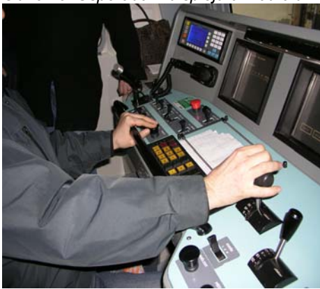
Obr.č. 6 Uspořádání displejů a materiálů na řídicím pultu řady 449
