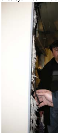
Obr. č. 7 Příklad „svépomocného“ utěsnění dveří proti hluku mezi kabinou strojvedoucího a strojovnou hnacího vozidla.
