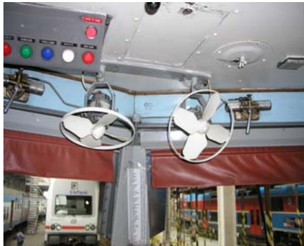
Obr. č. 7 Umístění ventilátorů v kabině strojvedoucího – časté u starších typů lokomotiv
