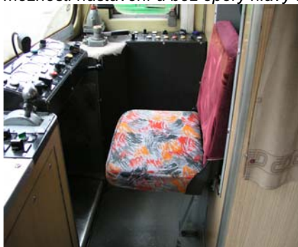
Obr. č. 5 Pevné sedadlo bez anatomického tvarování, i bez odpružení, bez jakékoliv možnosti nastavení a bez opěry hlavy a rukou u řady 810
