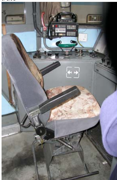
Obr.č. 8 Umístění vysílačky/ telefonu mimo oblast přímého směru pohledu SV při sledování tratě
