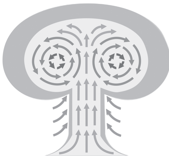
Obrázek 147: Charakteristické proudění žhavých plynů uvnitř atomového hříbu.
