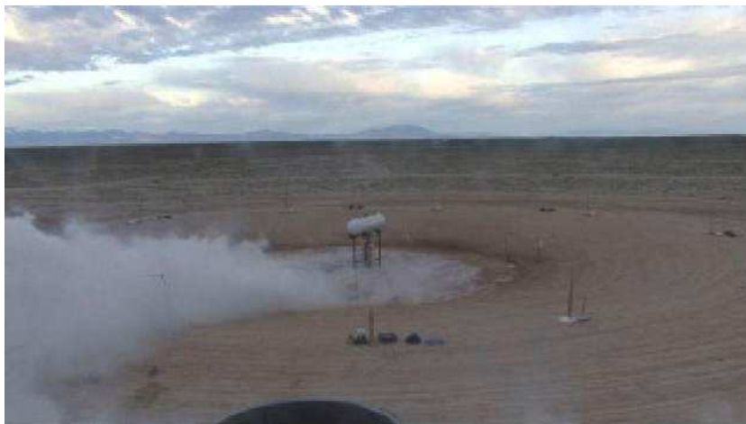
Obr. 6: Naředění oblaku aerosolu tvořeného amoniakem a jeho rozptyl pasivním způsobem (Jack Rabbit Test Program, U.S. Department of Homeland Security & U.S. Army, 2010) [15].
