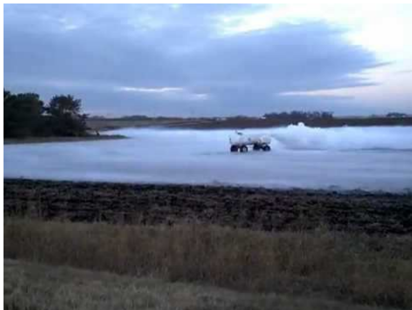
Obr. 1: Oblak aerosolu těžkého plynu za bezvětří [4].
