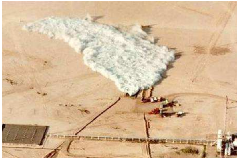
Obr. 4: Tečení oblaku aerosolu tvořeného fluorovodíkem (Goldfish Test Series, AMOCO Oil Company & Lawrence Livermore National Laboratory, 1986) [14].
