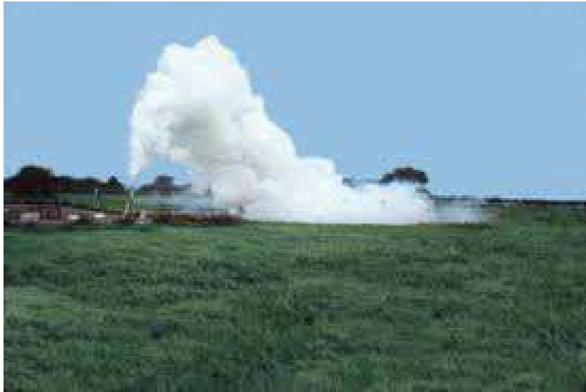
Obr. 3: Sesedání oblaku aerosolu tvořeného amoniakem při úniku typu „jet“ [13].
